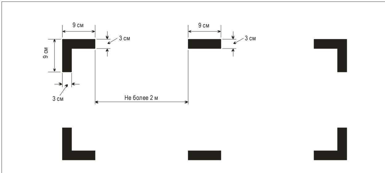
МАРКИРОВКА МЕСТ АВАРИЙНОГО ВСКРЫТИЯ ФЮЗЕЛЯЖА (см. п. 2.4.2.6)
